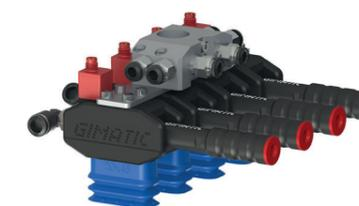
Mano di presa decentralizzata in prototipazione rapida
